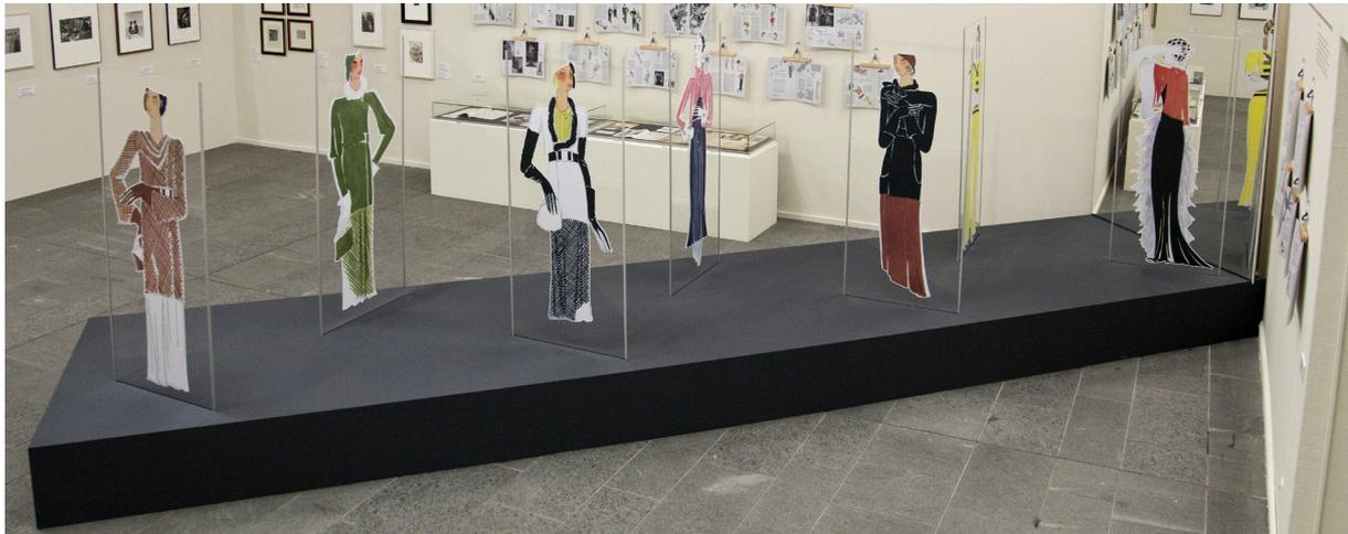
In den 40 cm hohen Laufsteg sind die 2 m hohen Plexiglasplatten versenkt und mit den Modeentwürfen beidseitig beklebt. Eine seitliche Führung aus Aluprofilen stabilisiert das Acrylglas.
